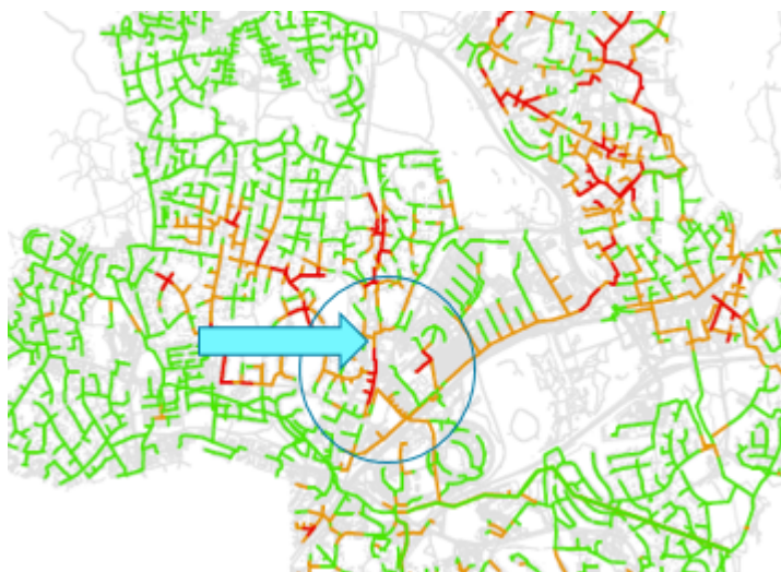
Figur 1: Ledningsnätet utifrån dimensionerande flöde, rött=kritiskt, orange=kan vara kritiskt. Kvarteret Strömmingen ligger vid pilen.
